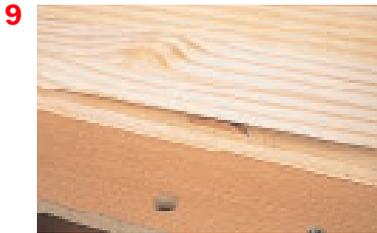
10. Utiliser le guide pour définir la hauteur des rainures sur des pièces épaisses.
