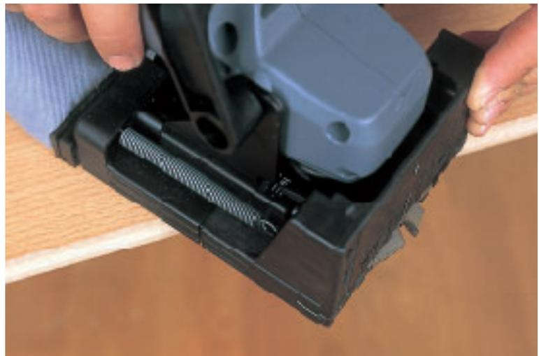
La rainureuse à lamelles est une machine simple qui a une structure semblable à celle d'une petite meuleuse. Elle est équipée d'une lame au carbure et d'un système de guide réglable à ressorts de rappel.
